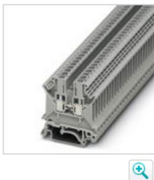
直通式接线端子, 连接方式: 螺钉连接, 接线容量: 0.2 mm<sup>2</sup> - 4 mm<sup>2</sup>, AWG: 24 - 12, 宽度: 5.2 mm, 颜色: 灰色, 安装类型: NS 32, NS 35/15, NS 35/7,5
